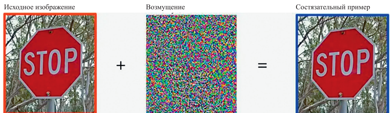
Рис. 1. Добавление «возмущений» для создания состязательного примера Fig. 1. Adding “perturbations” to create an adversarial example
