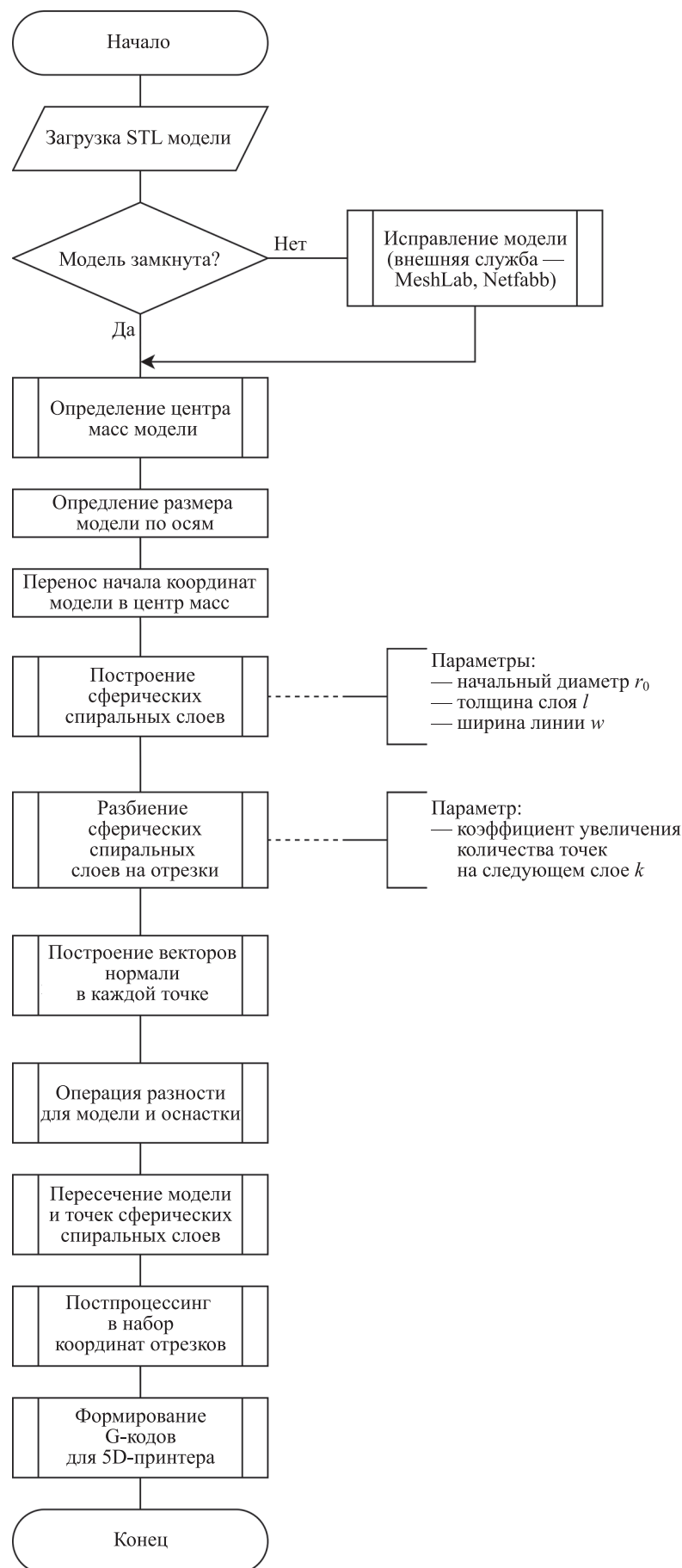
Рис. 1. Блок-схема алгоритма формирования многомерной траектории Fig. 1. Block diagram of the multidimensional trajectory generation algorithm
