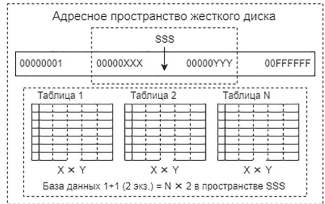
Рис. 2. Графическое представление базы данных SubBase
