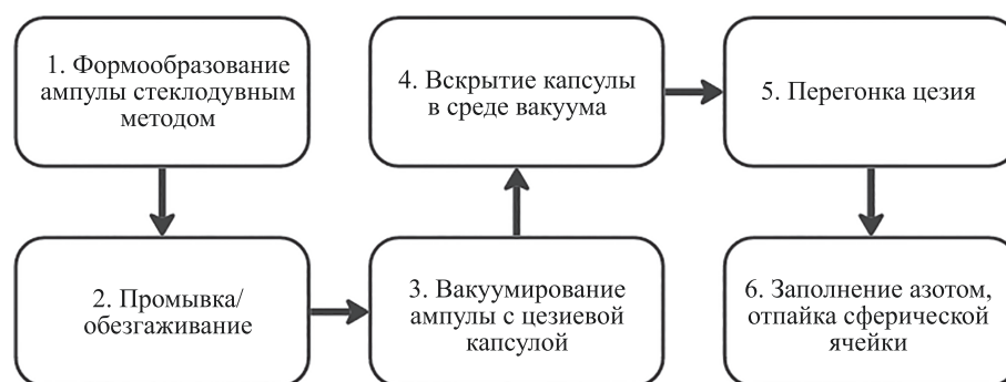
Рис. 7. Технологическая схема изготовления газовой ячейки
