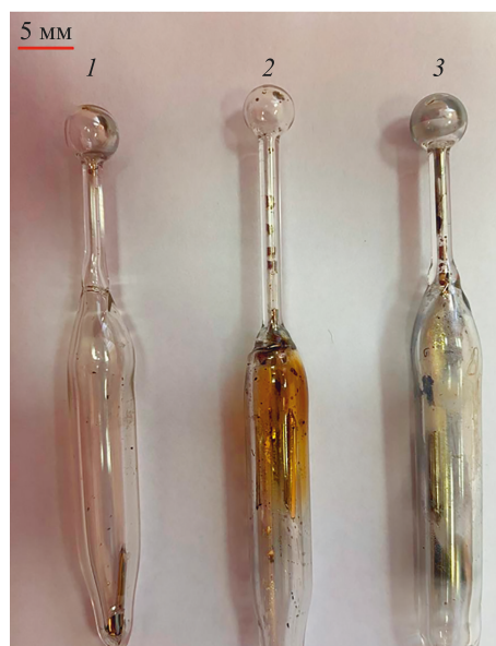
Рис. 4. Ампулы после заполнения цезием: 1 — вакуум 7,5 \cdot 10^{-9} торр; 2 — 50 торр азота; 3 — 100 торр азота
