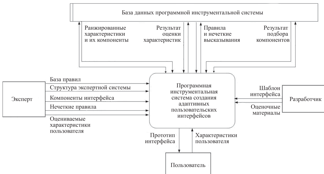
Рис. 1. Движение информационных потоков при работе программной инструментальной системы Fig. 1. The movement of information flows during the operation of the software development system
