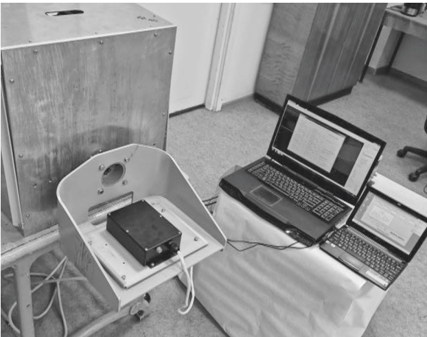
Рис. 3. Стенд качки с установленным электронным кренометром Fig. 3. Pitching stand with installed electronic inclinometer (EI)
