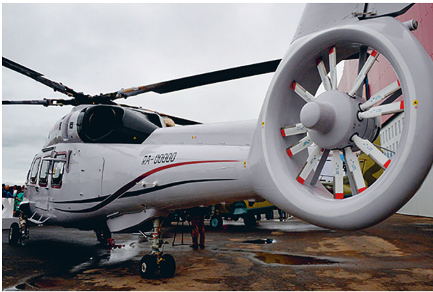
Рис. 1. Фенестрон со спаренными лопастями вертолета Ka-62
