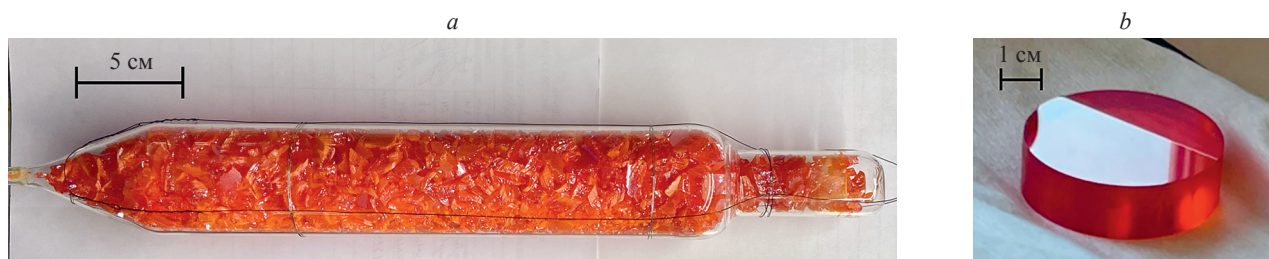
Рис. 1. Общий вид ампулы, заполненной шихтой ( a ) и заготовки после механической обработки полученного в ходе процесса монокристалла ( b )
