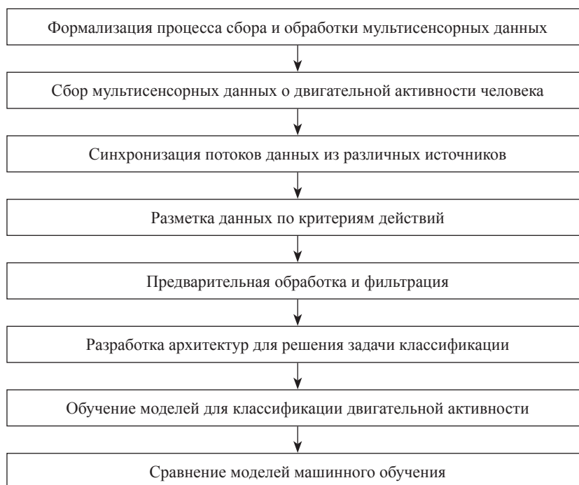
Рисунок. Структура обработки мультисенсорных данных Figure. Multisensory data processing framework
