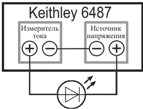
Рис. 5. Схема измерения темнового тока DFB-лазера Fig. 5. Measurement dark current setup of the DFB laser diode
